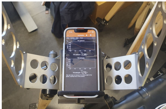
Figur A.12: Telefonhållare med telefon placerad under antenn för att mäta vinklar mot TV-masten och antennen. Appen som används heter phyphox.
