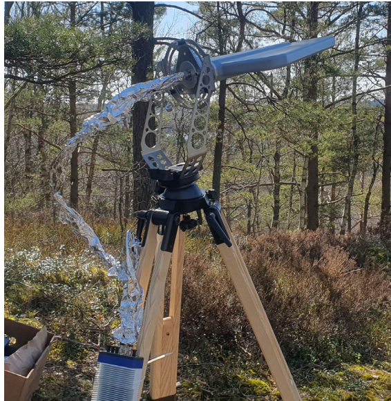
Figur 3.3: Antenn under fältmätning. Den anslöts med en koaxialkabel till en SDR. Koaxialkabeln täcktes med aluminiumfolie för att undvika störningar i signalen orsakat av solinstrålning.
