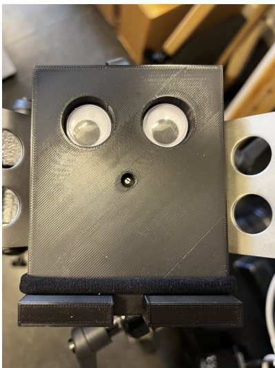
Figur A.11: Telefonhållare placerad under antenn för att mäta vinklar mot TV-masten och antennen.
