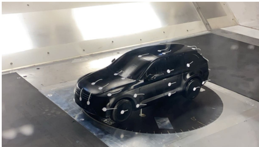
Figur 3.20: Bild av modellen i vindtunneln med tofsar.
