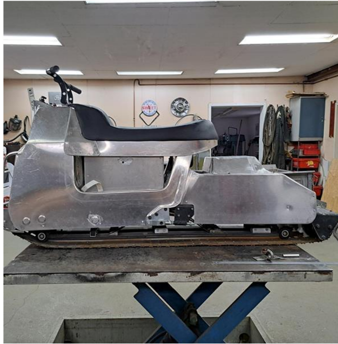
Figur 1.2: ELRV 2.0 under uppbyggnad där boggien är synlig närmast bordet. Drivlinan och chassie är nytt men boggien och mattan är tagen från en gammal Larvenmodell. Foto av Magnus Bredin. Använd med tillstånd.
