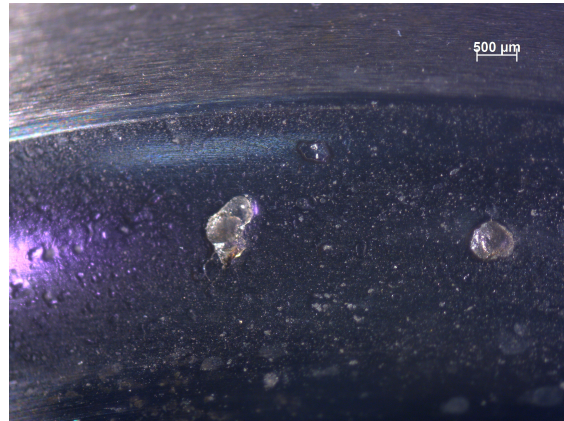
(d) Marks after two chipped off pieces
