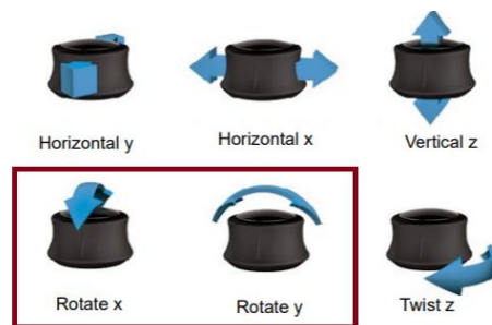
Figur 3. Frihetsgrader för SpaceMouse. (Megatron, 2024)
