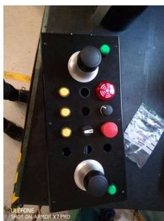
Figur 2. Bild på Hofpartners nuvarande styrpanel med två SpaceMouse
