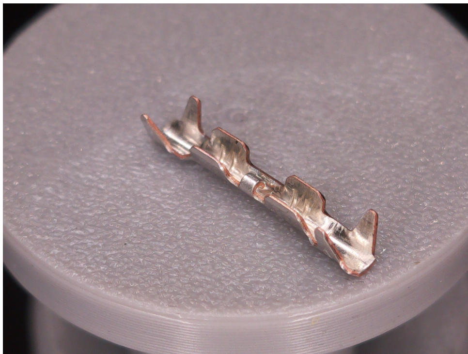
Figur 4.5: Exempelbild på en fotad terminalkontakt tagen med Arducam 64MP. Notera hur den bakre och främre delen av kontakten ej är i fokus.
