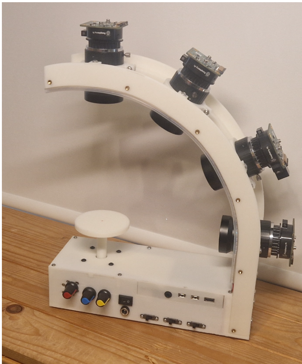
Figur 5.2: Det färdiga skanningssystemet. CSI-kablage till kameramodulerna är ej installerat på bilden. Systemet är ca 270*80*220 mm stort.
