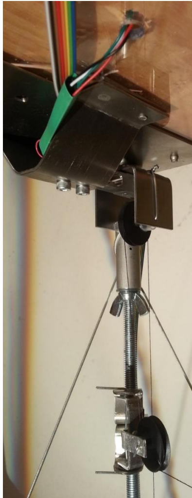
Figur 7.12 Trissa överst monterad på lastcellen och block nederst.
