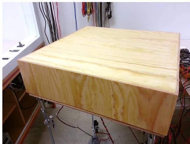
Figur 7.3 Skyddande trälåda för elektronik.
