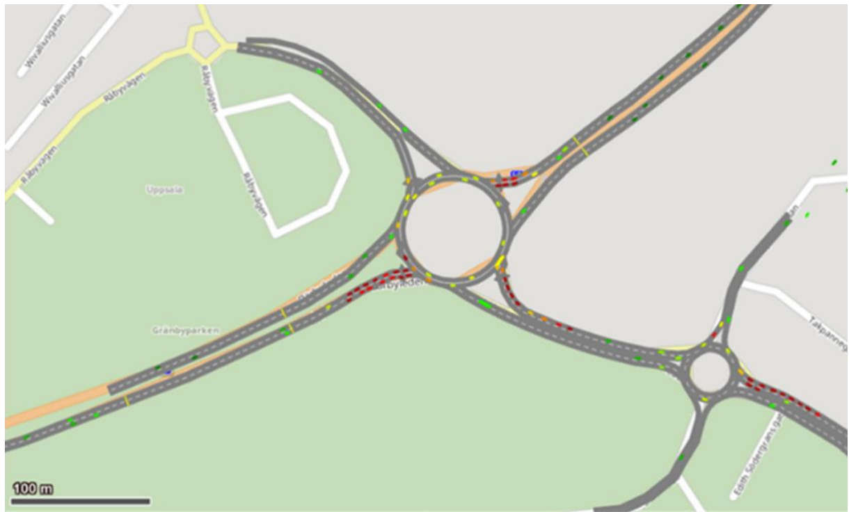
Figur 26: Stillbild från VISSIM över en implementering av Hasselcirkeln i stället för den nuvarande cirkulationsplatsen i Uppsala vid Bärbyleden.
