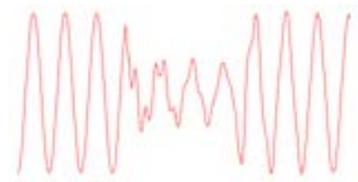
Figur 11. Sinuskurva med en spänningsdipp (Unipower, 2016).
