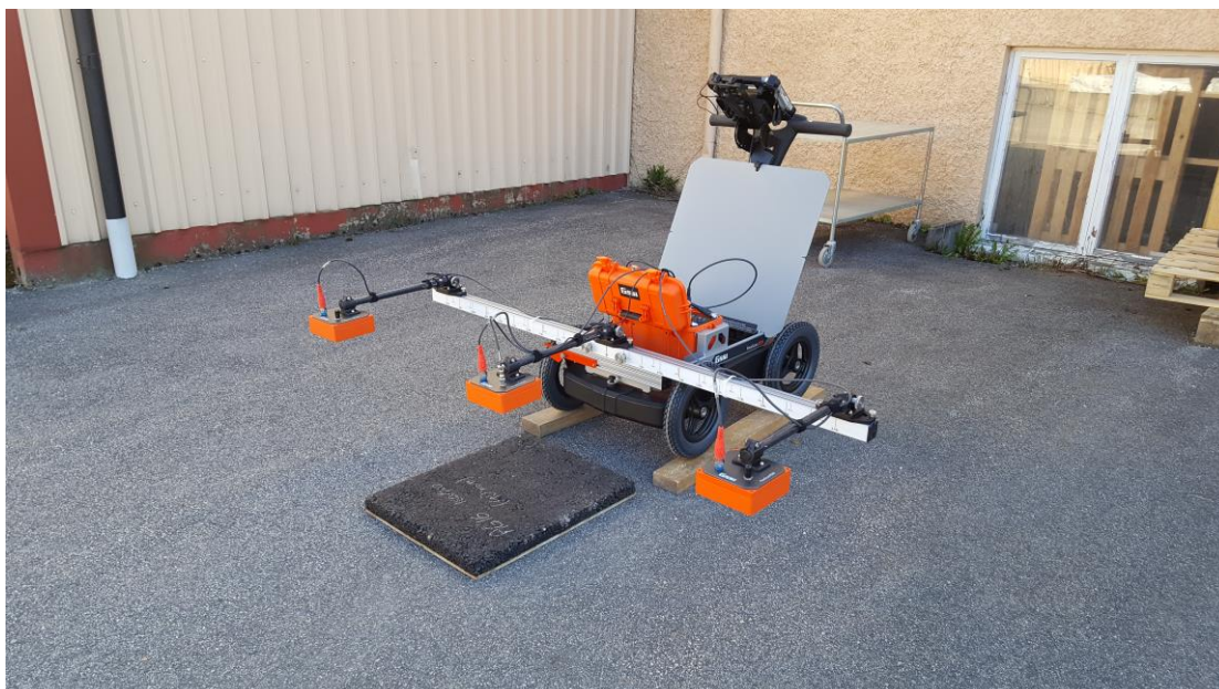
Figur 2 - Mätning av asfaltsplatta med upphöjd mätutrustning.
