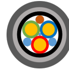
Figur 35: Designförslag en trefaskabel och en fiberkabel
