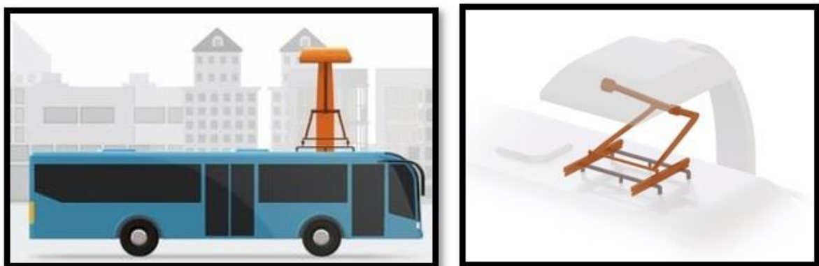
Figur 1. Strömavtagare i kontakt med laddningsskenorna. (OPPCharge,2019)
