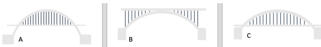
Figur B5.4. Typisk utformning för olika designkoncept av bågbro.
