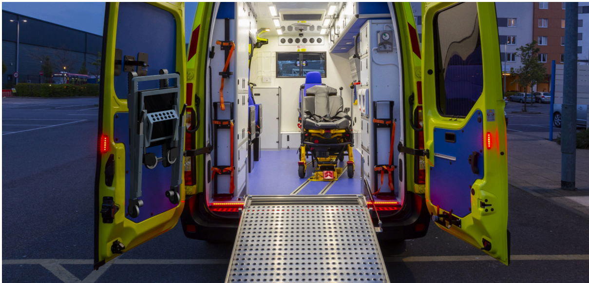
Figur 23. Stolen monterad på ambulansens baddörr
