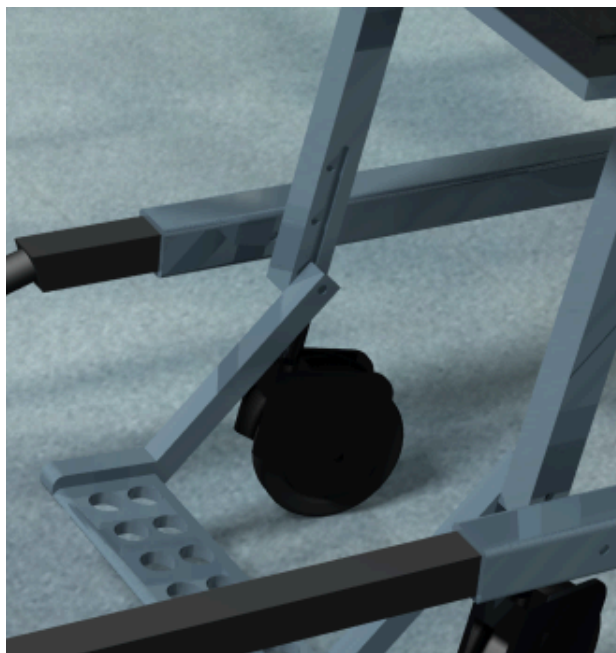
Figur 20. Detaljbild på justeringsmöjligheter av fotstödet
