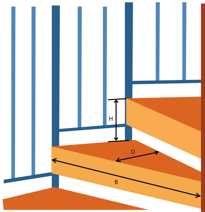
Figur 7. Illustration av steghöjd H , stegbredd B och stegdjup D i en spiraltrappa
