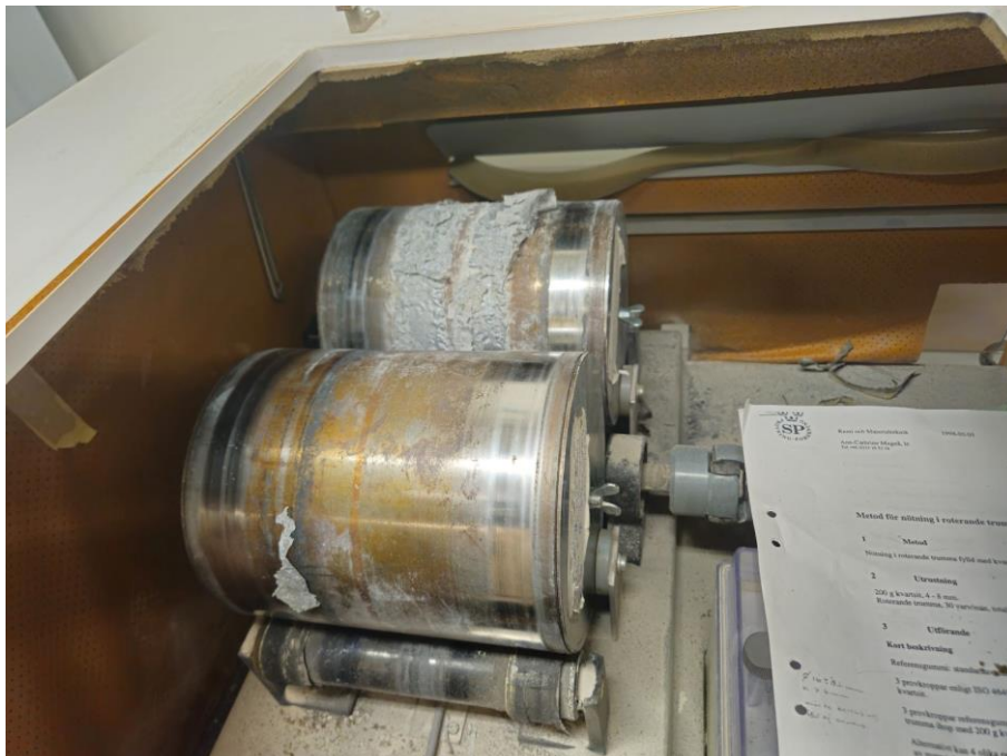
Figur 8, Närbild av nötning i trumma.
