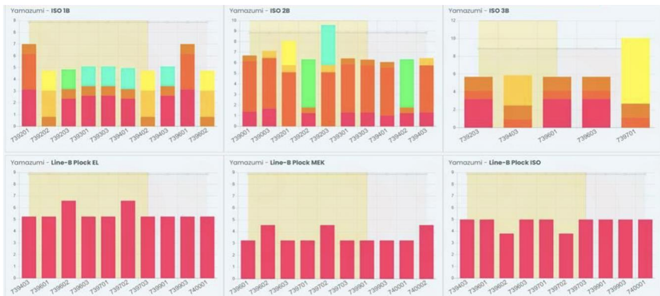
Figur 4.4 Stapeldiagrammen visualiserar beläggningsgraden i relation till takttiden per station. Y-axeln motsvarar minuter och x-axeln visar produktionsnumret (Swegon, 2022).
