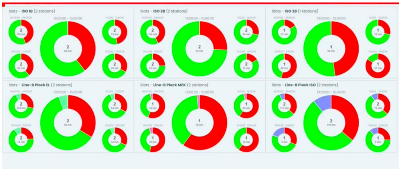
Figur 4.5 Cirkeldiagrammet visualiserar beläggning per station per arbetspass. Siffran i mitten av cirkeln visar bemanningsbehovet i antal operatörer och tiden under visar hur lång en operatör kan förflytta sig (Swegon, 2022).
