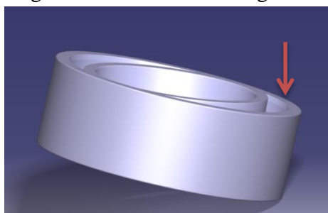
Figur 4.19. Illustrering av lagret, pilen markerar vilken ring som vinklas och i vilken riktning.
