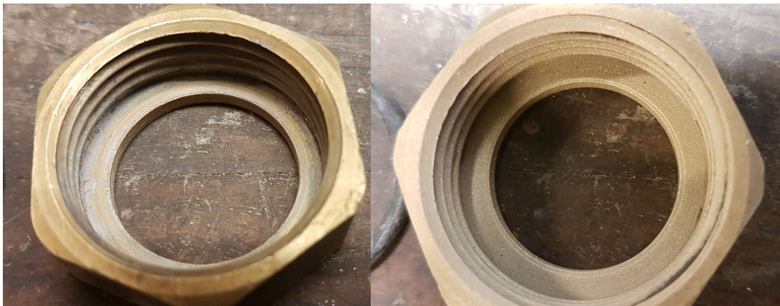
Figur 9.6: Före och efter blåstring av filterhållare. Författarnas egen bild.
