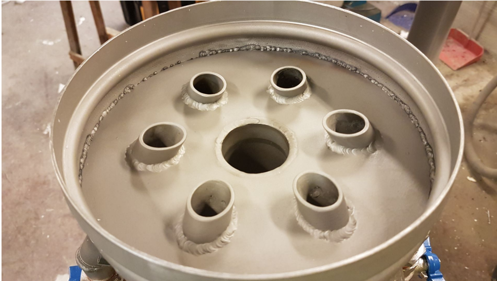
Figur 9.3: Insida bottendel av behållare. Hålet i mitten är kvar från tidigare designversion och utgör numer ingen funktion mer än för stödbenets låsning. Författarnas egen bild.
