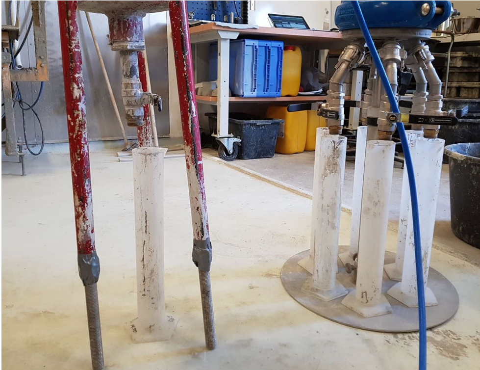
Figur 9.2: Skillnader mellan filterpressarnas design och antal ventiler. Författarnas egen bild.
