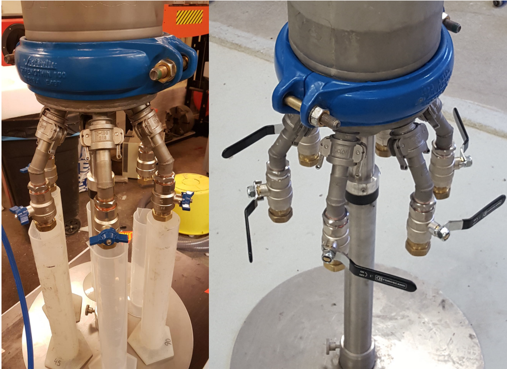
Figur 9.5: Före och efter byte av kulventiler. Författarnas egen bild.
