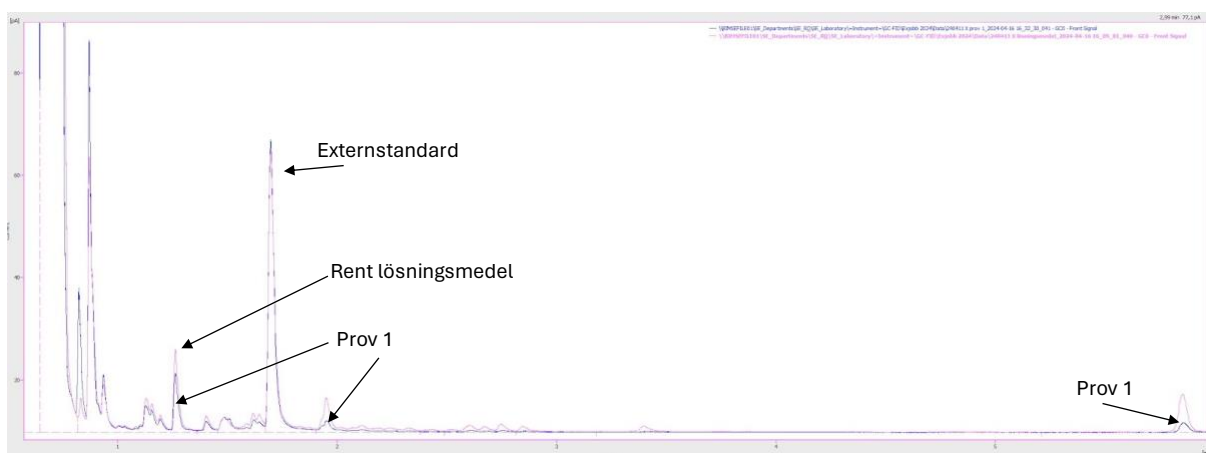
Figur 11. Prov 1 och rent lösningsmedel, båda är koncentrerade med externstandard.
