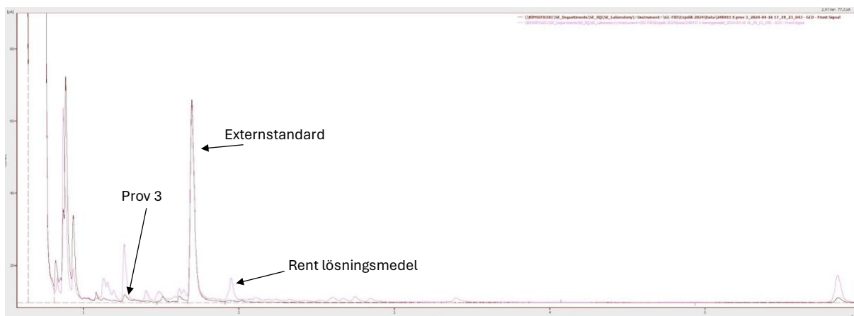
Figur 12. Prov 3 och rent lösningsmedel, båda är koncentrerade med externstandard.
