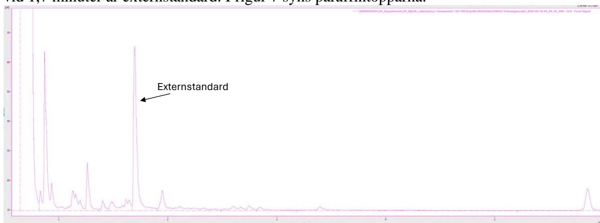
Figur 6. Koncentrerat rent lösningsmedel med externstandard, mellan 0–6 minuter.
