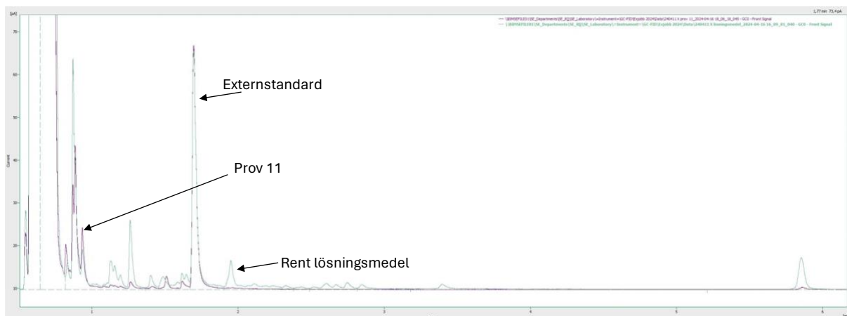
Figur 13. Prov 11 och rent lösningsmedel, båda är koncentrerade med externstandard.
