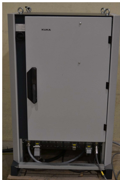
Figur 2 - Styrskåp KR C2 till robot.
