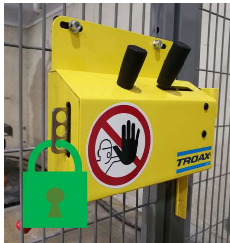
Figur 13 - Principen för att spärra ett SafeLock-lås i öppet läge.
