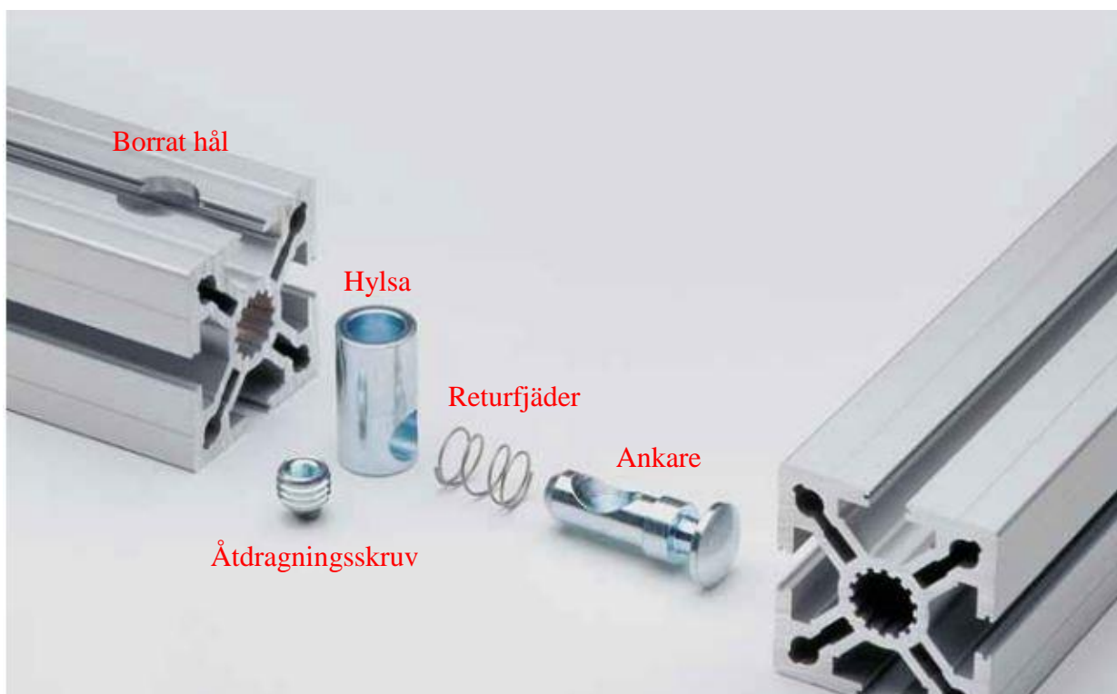
Figur B15 – Universalkopplingens olika delar
