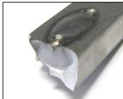
Figuren till vänster visar att utmattningshållfastheten för svetsat material är oberoende av statisk brottgräns, vid höga hållfastheter. Figur: Eriksson, 2006. Nere till höger: En påminnelse om att brott inte inträffar i själva svetsen. Det räcker alltså inte att överdimensionera denna (Bergsten, 2016).
