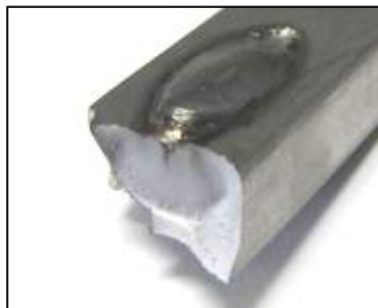
Exempel på anvisningar. Fotot visar utmattningsbrott vid svets (Bergsten, 2016).
