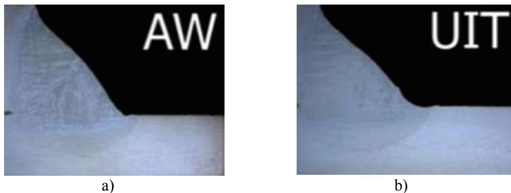
Figur 4.19 Obehandlad och HFMI-behandlad kälsvets (Bergsten, 2016).
