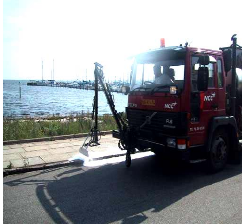
Bild 8 Applicering av Waipuna med fordon.
