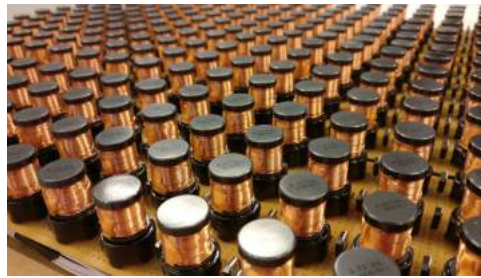
(d) Rutnät av elektromagneter.
