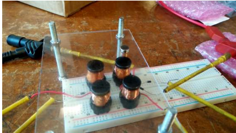
Figur 3.15: I bilden syns testuppsättningen med 4 drosslar av den typ som kommer att användas för schacket.
