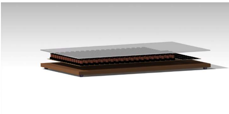
Figur 4.13: CAD-modell av de tre lagren utan sammanhållande skruvar.
