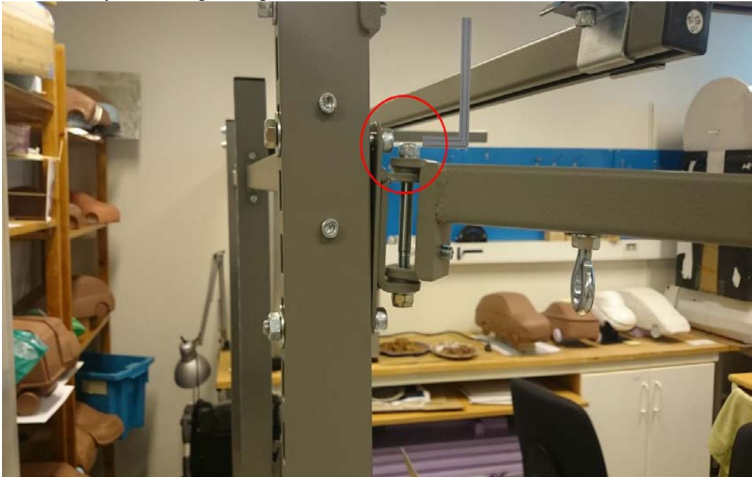
Figur 4.18 - Svängbar arm efter nio genomförda monteringssteg. Bilden en arm som hänger någorlunda på plats på pelaren inför det sista monteringssteget. Den visar även att en röd ring som ringar in pelarfästets övre skruvhuvud, gångjärnsledens övre skruvhuvud och en ditritad insexnyckel.
