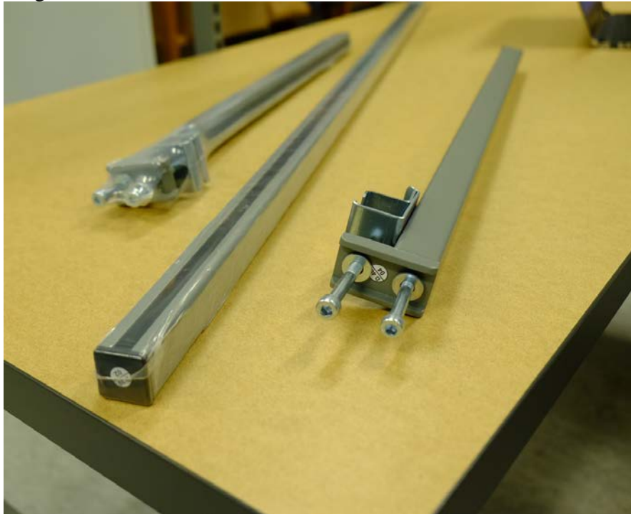
Figur 4.5 - Två fasta armar och en c-profil. Bilden visar två fasta armar med pelarfästen och fästen för tvärgående C-profilbalk, en tvärgående C-profilbalk, fyra skruvar och fyra brickor. En Fast arm och en tvärgående balk är fortfarande i emballage.
