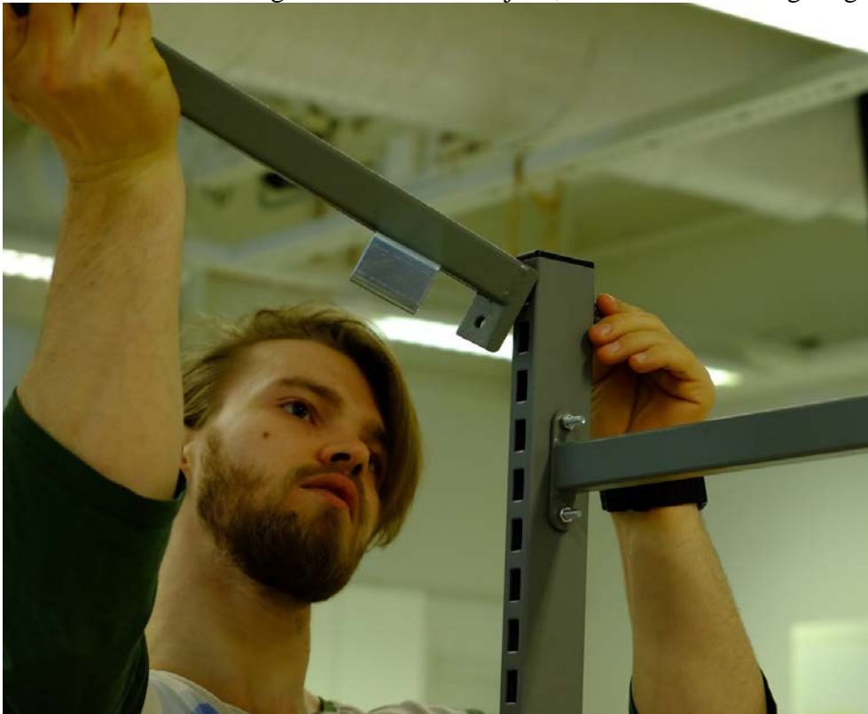
Figur 4.13 - Det sjätte monteringssteget av den fasta armen. Bilden visar en medelgod montör som försöker fästa en skruv genom pelarens två perforeringar i ett förgångat hål i armens fäste.
