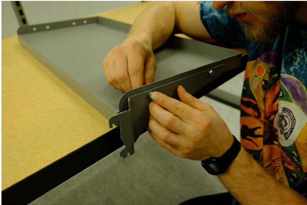
Figur 4.12 - Närbild av fästning av konsol i hyllplan. Bilden visar en konsol som fästs i ett hyllplan för hand med ett skruvförband.
