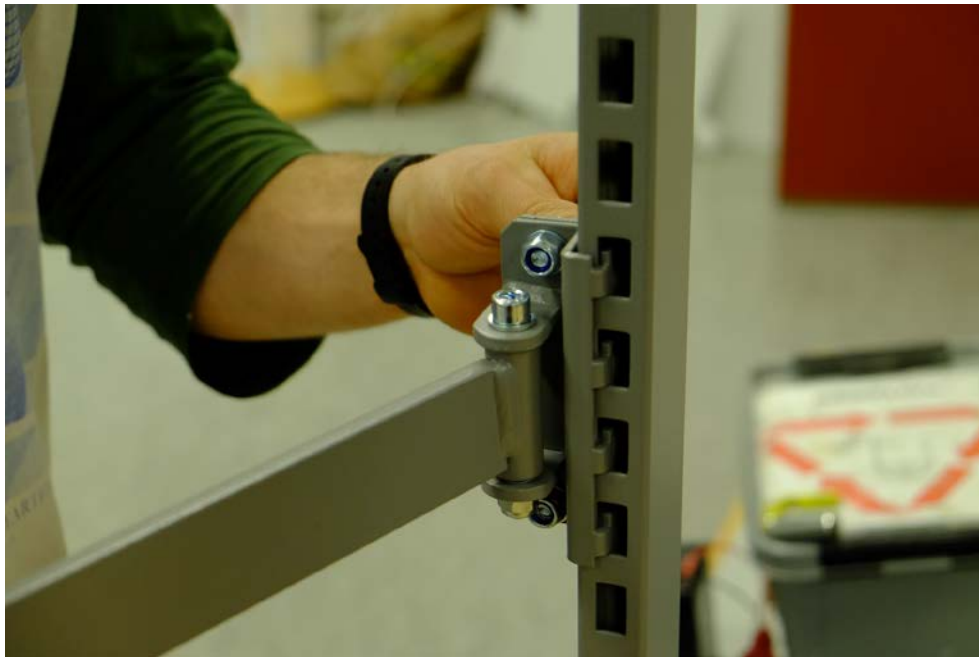
Figur 4.8 - WFI:s ledbara arm. Bilden visar hur komponenten är hakad i och fastklämd på en pelare.
