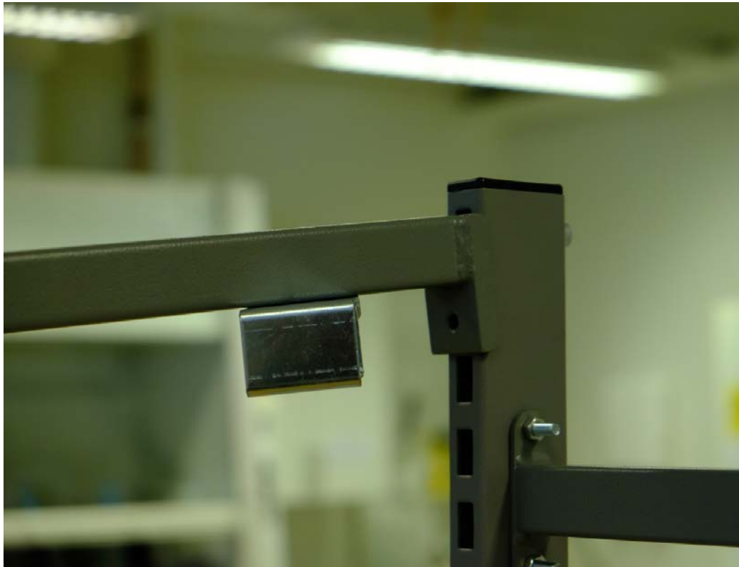
Figur 4.14 - Närbild av den fasta armen under montering. Bilden visar den fasta armen med pelarfästet, delvis monterad i den perforerade pelaren.
