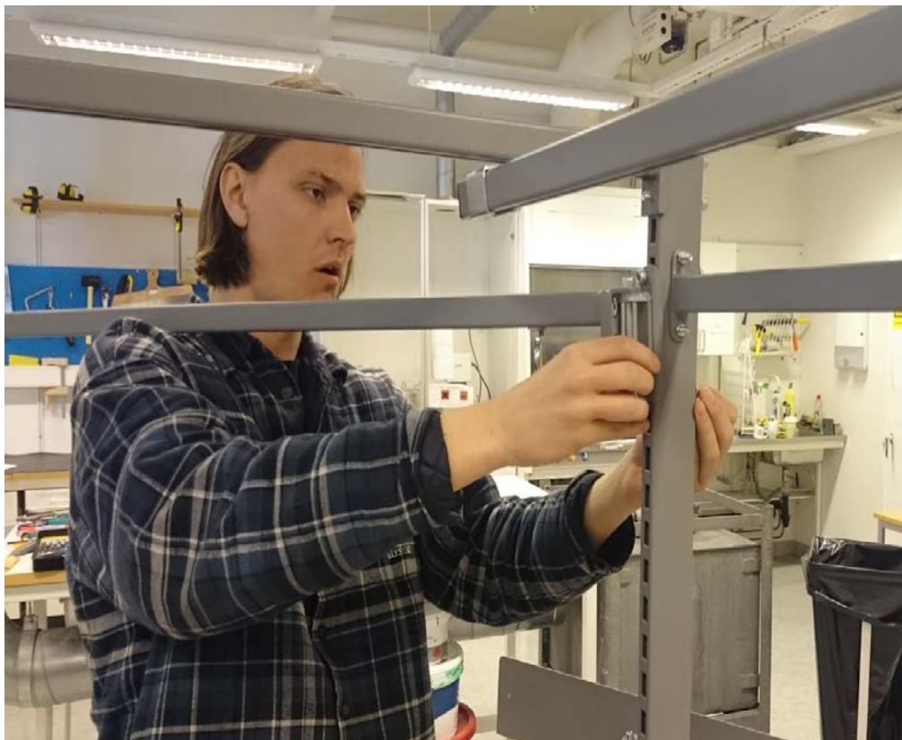
Fig 4.17 - Montering av svängbar arm med stöd av axel. Bilden visar en montör genomföra det kritiska 8:e monteringssteget.
