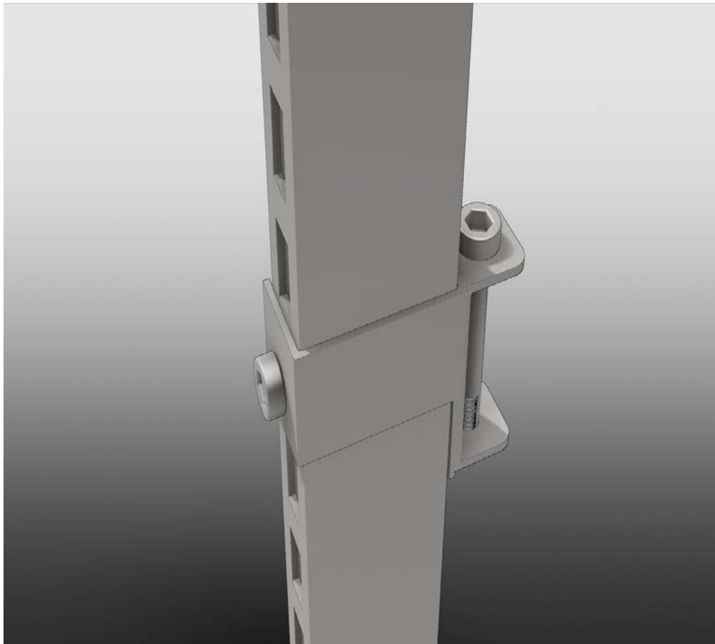
Figur 4.66 - Rendering av fäste för svängbar arm fastmonterat på pelare. Figuren visar konceptet då det är fäst på pelaren och fixerat med en skruv.
