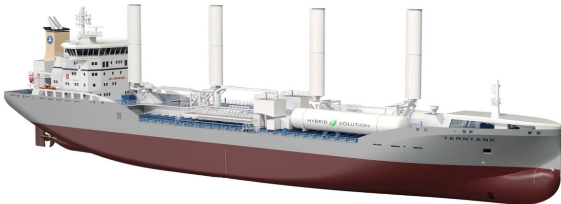
Figur 4. Fartyg från Terntank utrustat med sugsegel i uppfälld och nedfälld position.
