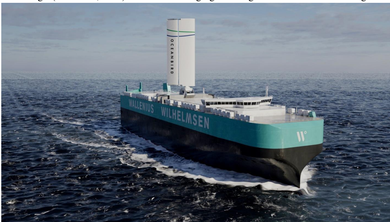
Figur 6. Vingsegel monterat och i drift på ett bilfraktfartyg.
