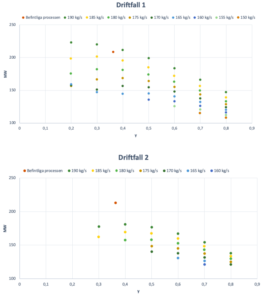
Figur 11: Den totala plasmaeffekten för båda driftfallen för processförändringen och brännarvärmets för den befintliga processen.
