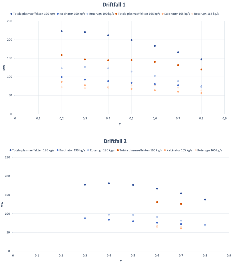
Figur 10: Total plasmaeffekt samt plasmaeffekt i roterugn och kalkinator, som en funktion av y för totala gasflödena 190 kg/s och 165 kg/s i de båda driftfallen.
