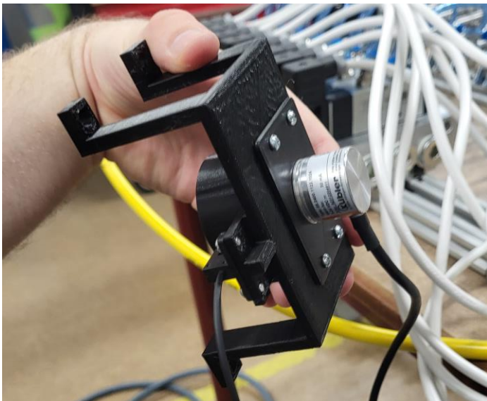
Figur 27 Optiskt öga, rotationsgivare och 3D-printat fäste.
