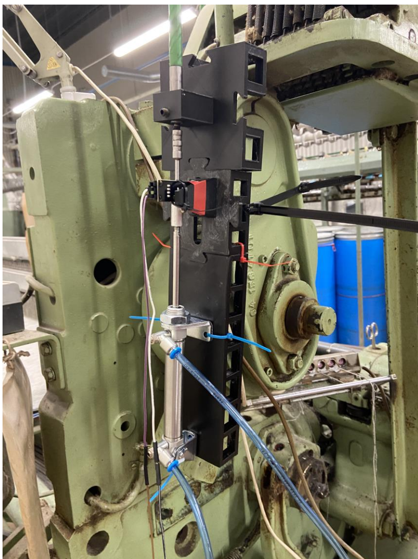
Figur 8 Färdig testtrigg kopplad med övriga komponenter och maskinen för att garantera att maskinen går att styra som planerat.
