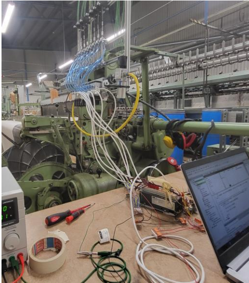
Figur 29 Ramen med pneumatiken monterad på maskinen bakifrån
