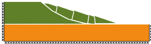
Figur 18. Dränerad ler- och sandslänt i i LimitState.
