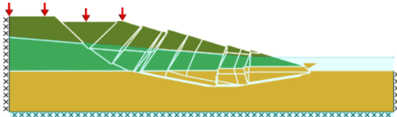
Figur 24. Odränerad ler-och sandslänt med yttre last och grundvatten i LimitState.
