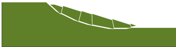
Figur 10. Dränerad lerslänt i LimitState.
