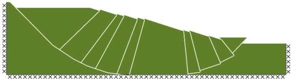
Figur 12. Odränerad lerslän i LimitState.
