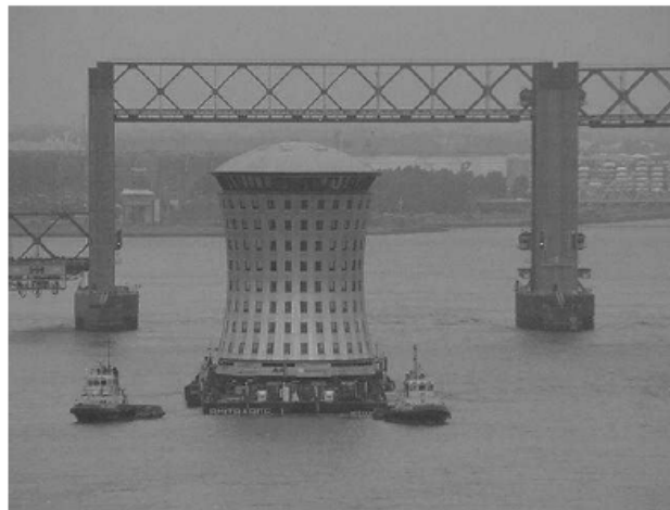
Figur 3.11: Ett fullständigt fabriksstillverkat 10-vånings kontor på väg till grundläggning (Scheublin och Egmond, 2005).
