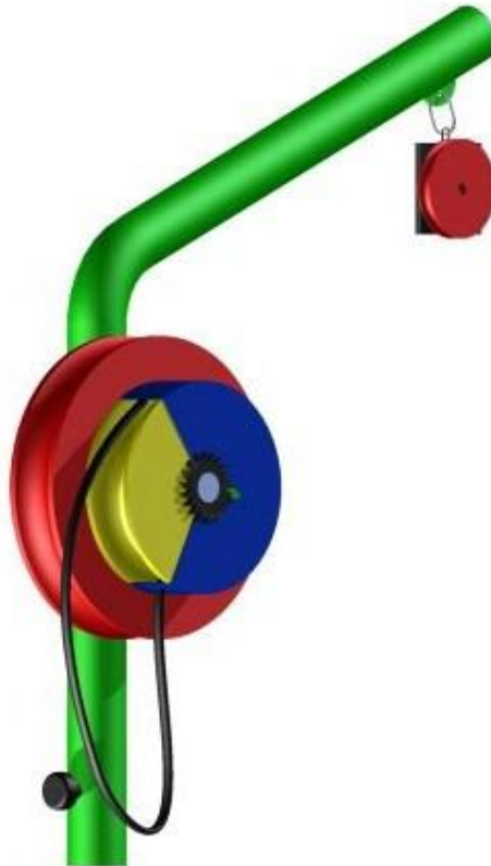
Figur 5.1 Koncept 1: Armatur som drivs med hjälp av ett rep
