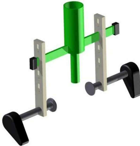
Figur 6.2 Fäste som använder sig av båtens årtull.
