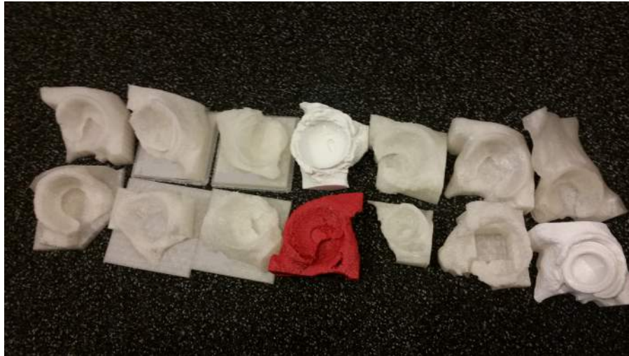
Figur 15: De 14 framtagna hårdplast modellerna av höftleder. De olika färgerna beror på plastens färg i skrivaren och är inget som påverkar mätningarna.
