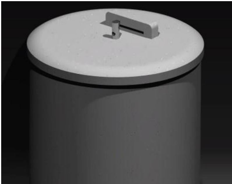
Figur 12. CAD-modell på koncept brunnslock 1.
