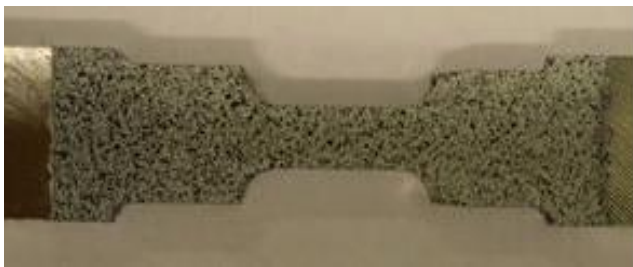
Figur 3.3, En provstav som blivit sprayad med vit och svart färg för att skapa ett slumpmässigt mönster som metoden kan registrera.
