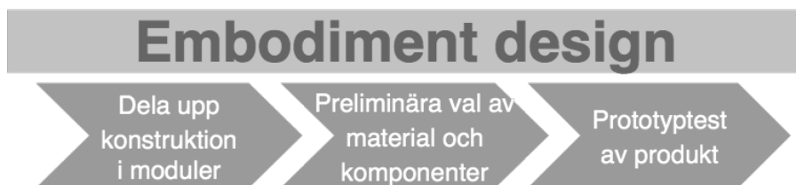
Figur 3.2 - Steg som genomförs under Embodiment design fasen
