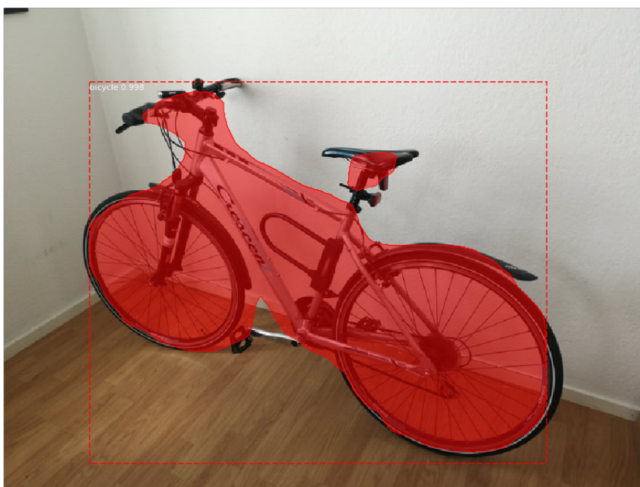
Figur 4.2: Exempel på segmentering med Mask R-CNN
