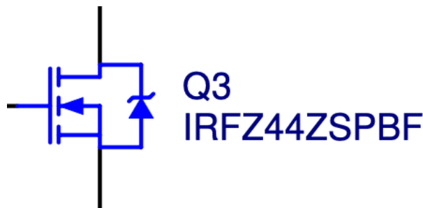
Figur 4.2: IRFZ44ZSPBF n-MOSFET, med kontakten gate till vänster, source nertill samt drain upp till.
