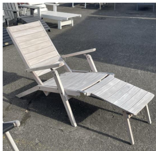
Figur 4.5: Obehandlad däckstol i teak som stått ute en säsong
