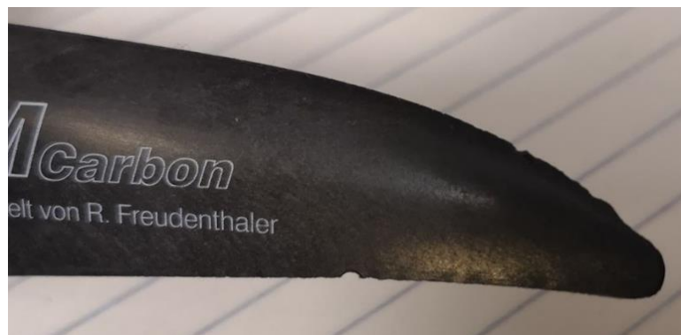
Figur 3.11. Ett propellerblad med synliga skador som inte använts i jämförande testning.
