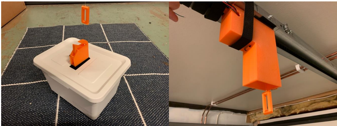
Figur 35 Lasten är levererad och uppvinschning av linan påbörjas
