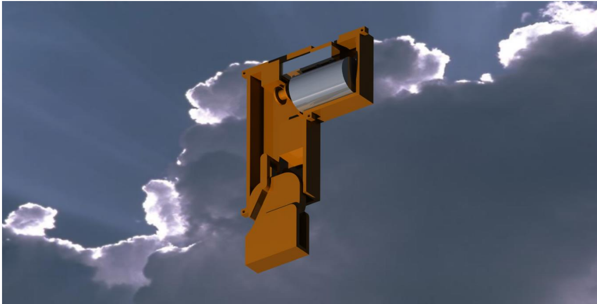
Figur 22 Rendering av vinschanordningen
