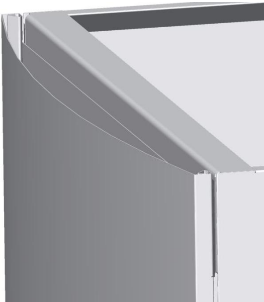
Figur 4.16 Dörr utan plastdetalj, icke solit intryck
