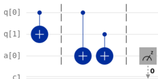
Figur 5: Kvantkrets över stabiliseringsmätning och syndromextraktion av en tvåkvantbit-repetitionskod. Före första barriären sammanflätas två kodande kvantbitar q[0] och q[1] med hjälp av en CNOT-grind för att bilda en logisk kvantbit (tvåkvantbit-repetitionskod). Efter första barriären tillämpas två CNOT-grindar på en ancillabit a[0] som målkvantbit med respektive kodande kvantbit som kontrollkvantbit. Efter sista barriären mäts slutligen ancillabiten på en klassisk bit c1 för att extrahera syndromet. Notera att endast ancillabiten mäts, vilket innebär att tillståndet för de kodande kvantbitarna ej kollapsar.
