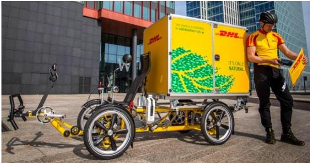
Figur 2.1: Bild på en Cubicycle med tillhörande lastbox.
