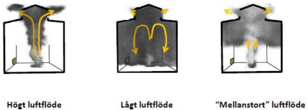
Figur 7 Den termiska plymen vid deplacerande ventilation (Personlig kommunikation Ekberg, 26 mars 2021)
