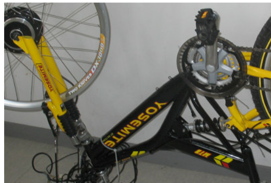
Bild 1: Ramen som används i projektet
