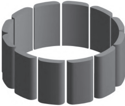
Figur 3.15: En cirkulär magnetkonfiguration med avrundade permanentmagnetkanter.
