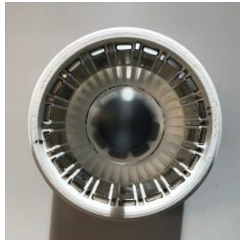
Figur 3.3: Rotor med permanentmagneter och axel
