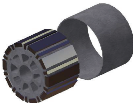
Figur 6.1: Figuren illustrerar den planerade rotorn med IPM.
