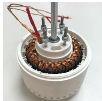
Figur 3.4: Stator och rotor monterade
