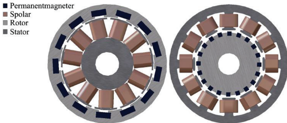
Figur 3.6: Till vänster en inrunner, till höger en outrunner.
