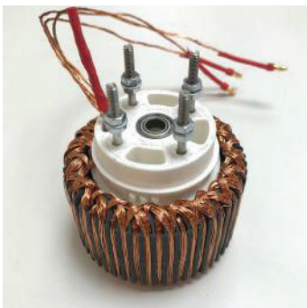
Figur 3.2: En stator som är lindad med koppartråd
