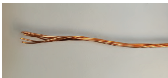
Figur 6.2: Figuren visar 6 stycken koppartrådar som tvinnats till en tjockare tråd.
