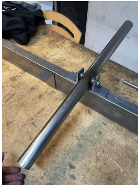
Figur 34: Framaxel under konstruktion
