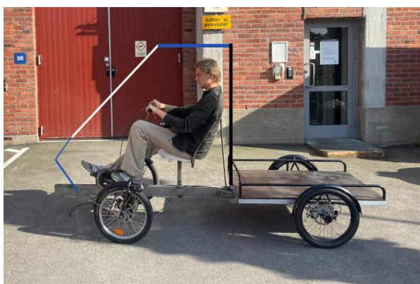
Figur 37: Koncept 2 (lång hjulbas)
