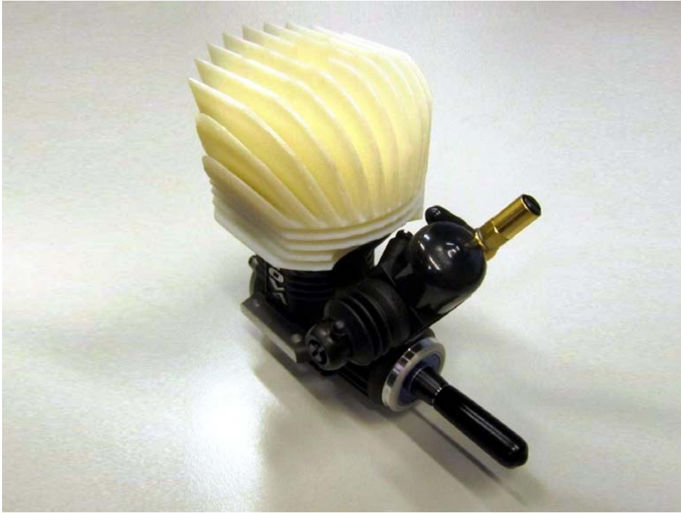
Figur 24. Den utskrivna modellen monterad på motorn.
