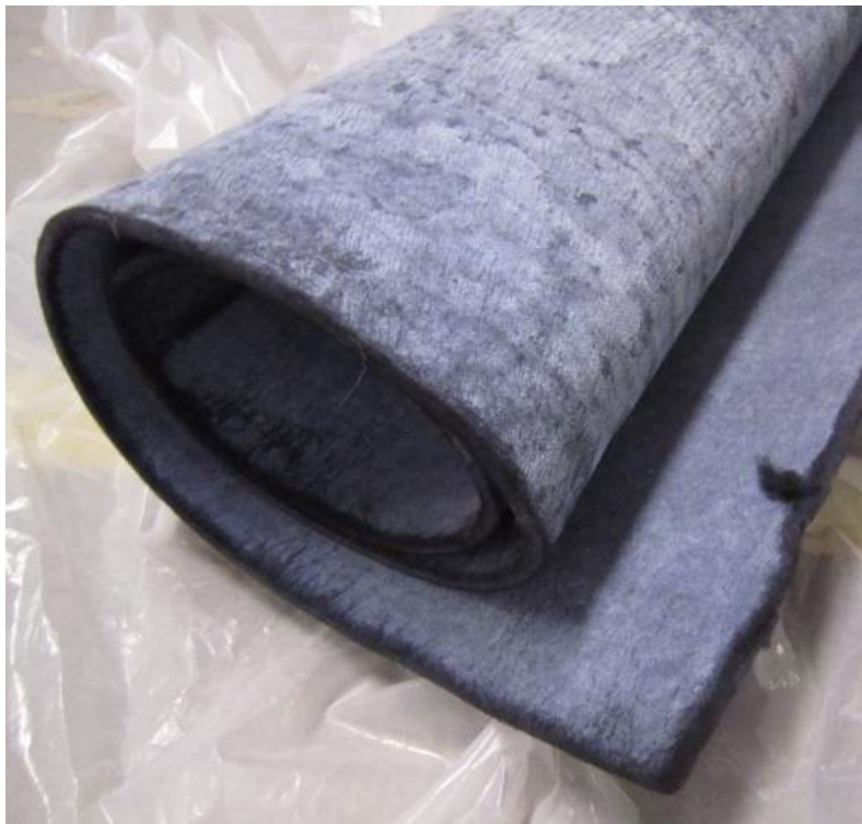
Figur 14. Aerogelmatta där aerogel har vävts samman med plast (Berge & Johansson, 2012).
