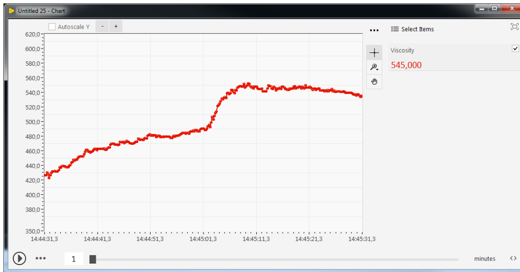
Figur 5.1: Viskositetsvariation under testkörning med grädde. Tiden är representerat på X-axeln medan viskositet är representerad av Y-axeln.
